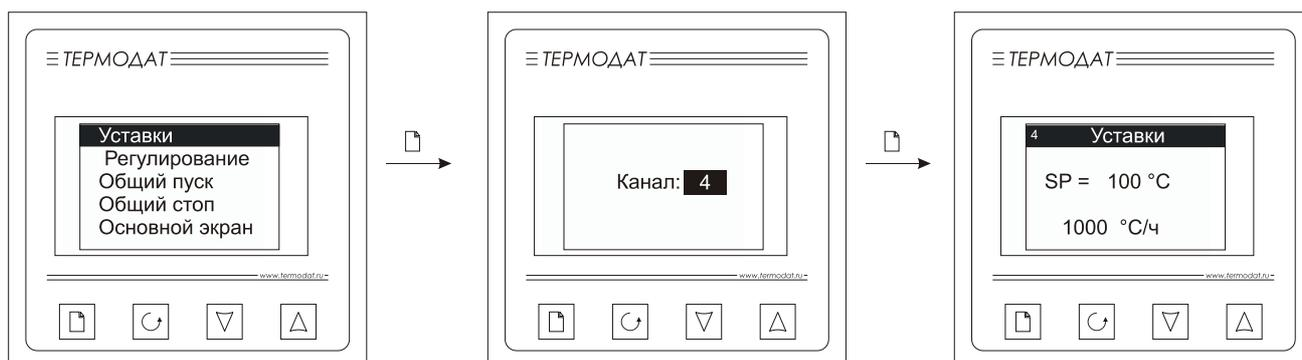
Нажмите . В меню быстрого выберите параметр «Регулирование» и присвойте ему значение «да». Включится регулирование на выбранном канале. Выбирайте значение «Пауза», чтобы приостановить регулирование.
