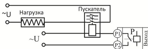
Подключение нагрузки более 1,5 кВт
