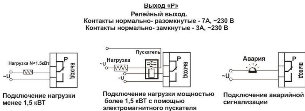
Рисунок 6. Схемы подключения релейных выходов.
